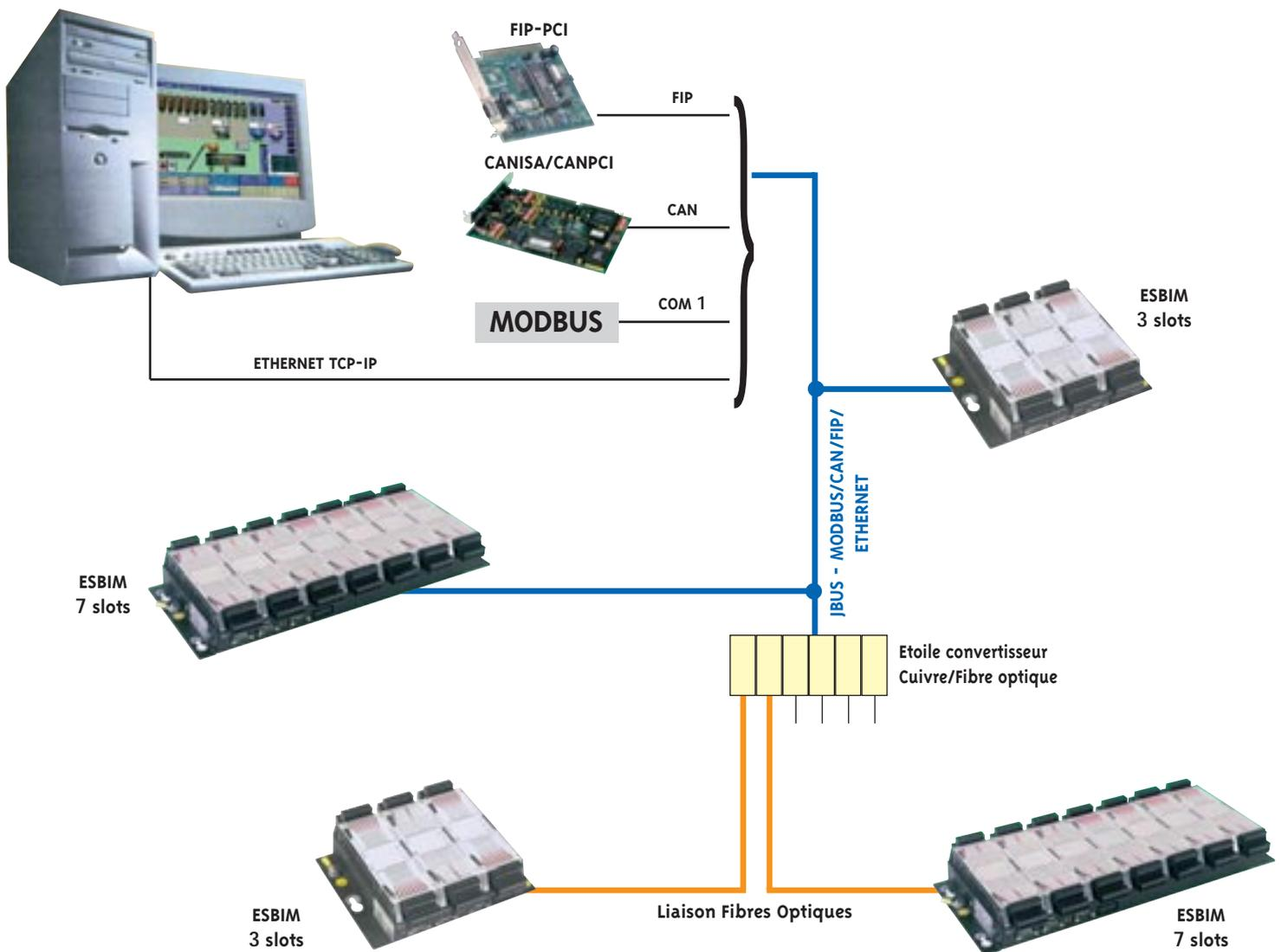
Le produit ES BIM se décline en version 3 slots qui en fait un produit très compact, pouvant supporter jusqu'à 72 entrées ou 48 sorties, TOR, et l'ensemble des modules BIM de la gamme BiBox.
